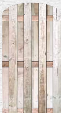
■ 40 PŁOT pionowy z łukiem - 9 deskowy przekrój deski - 15 mm x 140 mm przekrój rygla - 15 mm x 75 mm szerokość - 900 mm • wysokość - 1800 mm
