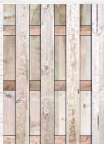
■ 44 PŁOT pionowy prosty - 10 deskowy przekrój deski - 15 mm x 140 mm przekrój rygla - 15 mm x 75 mm szerokość - 900 mm • wysokość - 1500 mm
