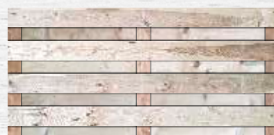
■ 63 PŁOT poziomy prosty - 11 deskowy przekrój deski - 15 mm x 140 mm przekrój rygla - 15 mm x 75 mm szerokość - 1800 mm • wysokość - 900 mm
