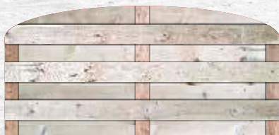
■ 64 PŁOT poziomy z łukiem - 9 deskowy przekrój deski - 15 mm x 140 mm przekrój rygla - 15 mm x 75 mm szerokość - 1800 mm • wysokość - 900 mm
