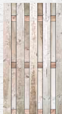
■ 39 PŁOT pionowy prosty - 11 deskowy przekrój deski - 15 mm x 140 mm przekrój rygla - 15 mm x 75 mm szerokość - 1800 mm • wysokość - 900 mm
