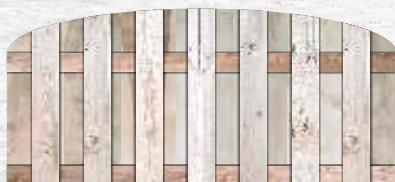
■ 28 PŁOT pionowy z łukiem - 15 deskowy przekrój deski - 15 mm x 140 mm przekrój rygla - 15 mm x 75 mm szerokość - 1800 mm • wysokość - 900 mm
