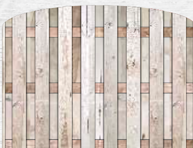
■ 23 PŁOT pionowy z łukiem EXL - 17 deskowy przekrój deski - 15 mm x 140 mm przekrój rygla - 15 mm x 75 mm szerokość - 1800 mm • wysokość - 1500 mm
