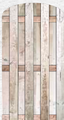
■ 41 PŁOT pionowy z łukiem - 10 deskowy przekrój deski - 15 mm x 140 mm przekrój rygla - 15 mm x 75 mm szerokość - 900 mm • wysokość - 1800 mm
