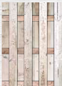
■ 43 PŁOT pionowy prosty - 9 deskowy przekrój deski - 15 mm x 140 mm przekrój rygla - 15 mm x 75 mm szerokość - 900 mm • wysokość - 1500 mm
